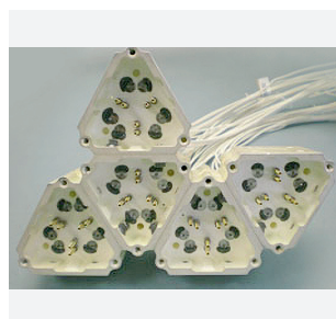
Рис. 21. Комбинация переключателей на основе Y-циркуляторов с применением цифровых систем управления. Время переключения каналов – <2 мкс, частота коммутации – 6 кГц
